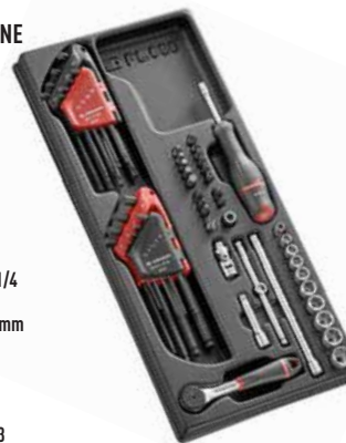
MODUŁ Z SZEŚCIOKĄTNYMI NASADKAMI 1/4" - KLUCZE I KOŃCÓWKI NARZĘDZIOWE SZEŚCIOKĄTNE I TORX MOD.R161-46 - Nasadki R.: 5,5 - 6 - 7 - 8 - 9 - 10 - 11 - 12 - 13 - 14 mm - R.161B: grzechotka 1/4" - R.209 i R.215: 2 przedłużenia 55 i 150 mm - R.236A: rękojeść obrotowa 158 mm - R.240A: przegub 1/4" - R.120A: przesuwna rękojeść 1/4" - 83SH.JPAA: zestaw 9 kluczy imbusowych w etui (1,5 - 2 - 2,5 - 3 - 4 - 5 - 6 - 7 - 8 mm) - 89S.JP8A: zestaw 8 kluczy kulistych torx w etui (10 - 15 - 20 - 25 - 27 - 30 - 40 - 45 mm) - R.235: uchwyt na końcówki Kończówki narzędziowe: Płaskie: 6,5 - 8 mm Sześciokątne: 3 - 4 - 5 - 6 - 7 mm Phillips®: 1 - 2 - 3 Pozi driv®: 1 - 2 Resistorx®: 10 - 15 - 20 - 25 - 30 - Wkładka formowana termicznie: PL.658
