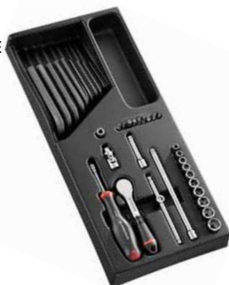
MODUŁ Z SZEŚCIOKĄTNYMI NASADKAMI 1/4" - SZEŚCIOKĄTNE KLUCZE I KOŃCÓWKI NARZĘDZIOWE MOD.R161-26 - Nasadki R.: 5,5 - 6 - 7 - 8 - 9 - 10 11 - 12 - 13 - 14 mm - R.161B: grzechotka 1/4" - R.209-215: 2 przedłużenia 55 i 150 mm - R.240A: przegub 1/4" - R.120A: przesuwna rękojeść - R.235: uchwyt na końcówki narzędziowe - R.236A: rękojeść obrotowa 158 mm - 82H.: 2 - 2,5 - 3 - 4 - 5 - 6 - 7 - 8 - 9 - 10 mm Kończówki narzędziowe: Płaskie: 4,5 - 6,5 - 8 mm Sześciokątne: 3 - 4 - 5 - 6 mm Pozi driv®: 1 - 2 - Wkładka formowana termicznie: PL.L13
