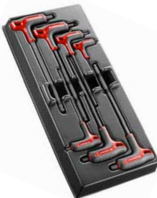
MODUŁ Z 7 KLUCZAMI IMBUSOWYMI Z RĄCZKĄ „P” I GŁÓWKĄ KULISTĄ MOD.84TZSA - 84TZSA.: 3 - 4 - 5 - 6 - 7 - 8 - 10 mm - Wkładka formowana termicznie: PL.MM-A Ciężar: 0,996 kg
