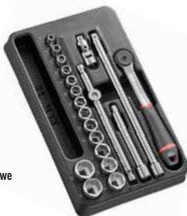
M MODUŁ Z SZEŚCIOKĄTNYMI NASADKAMI 3/8" Z GRZECHOTKĄ MOD.J161-36 - Nasadki: JH.7 - 8 - 9 - 10 - 11 - 12 - 13 - 14 - 15 - 16 - 17 - 18 - 19 - 21 - 22 mm - J.161B: grzechotka 3/8" (szczelna) - J.210 - 215: 2 przedłużenia 125 i 250 mm - R.240A: przegub uniwersalny - R.120A: przesuwna rękojeść - Wkładka formowana termicznie: PL.M15 Wymiary: 31 x 18,8 x 3,7 cm
